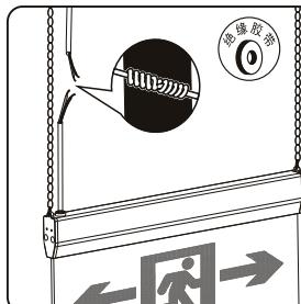
2 按接线图正确接线，并做好绝缘防护处理
