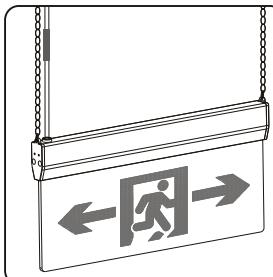
3 接通电源，然后在控制器中进行模拟试验灯具是否正常工作
