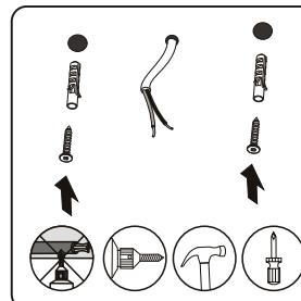
1 根据灯具两侧堵头吊挂孔距在天花板上打孔，并装入墙塞和螺丝
