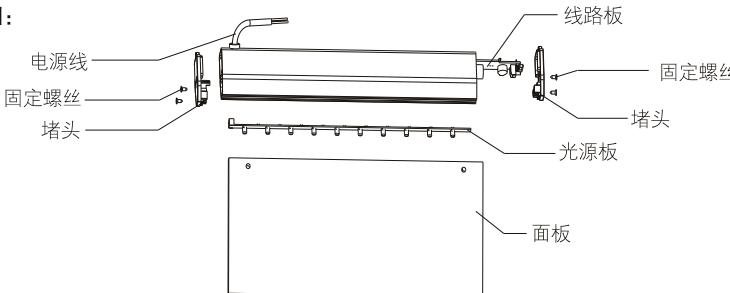
安装示意图：(吊装配件：吊链或吊绳请自行购买)
