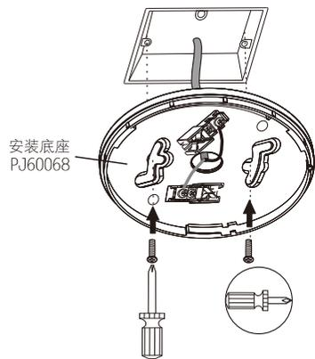
2 将安装底座安装于86盒上，再按接线标识正确接线
