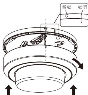
3 灯身I字形标识对准安装底座的三角形▽标识，将灯身推进安装底座，并顺时针旋转锁紧
