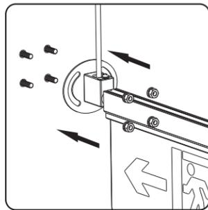
将灯具安装于膨胀螺丝上，并用螺母锁紧
