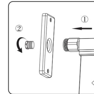
将侧装配件安装于出线端的螺丝上
