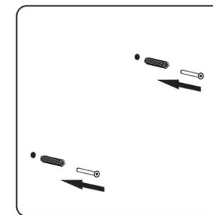
在墙体根据配件孔位钻孔，并安装好墙塞和螺钉
