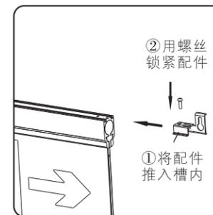
将吊装配件安装于灯具顶部槽内
