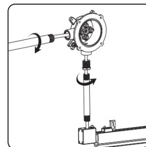
将防爆接线盒用铁管与灯具连接，并将电源线从防爆接线盒中穿出
