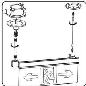
将吊绳旋转进吊装配件上；将铁管旋转进防爆接线盒上，并将电源线从铁管中穿出
