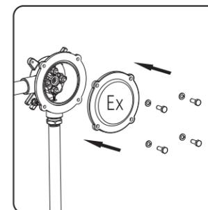
将电源线连接于端子上，并用螺母锁紧面盖
